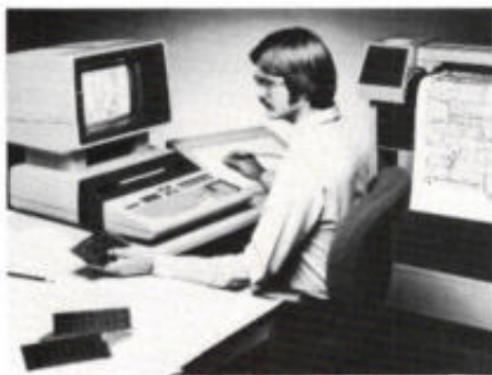
Fig. 1. CAD/CAM-werkstation met data-invoer via een toetsenbord, menuveld en vrijehand-symbolen.
