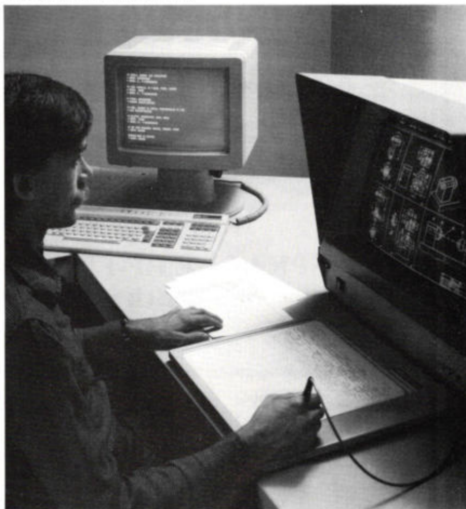
Afb. 1. Een CAD-systeem voor het maken van constructietekeningen, beschikt veelal over twee beeldschermen: één met een hoog oplossend vermogen waarop de tekening wordt afgebeeld – de opdrachten worden m.b.v. een „menu-tablet“ ingevoerd – en een alfanumeriek scherm waarop de commando's en acties worden weergegeven in het vakjargon van de constructeur. (Foto: Océ van der Grinten NV, Venlo).
