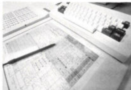
Fig. 2. Toetsenbord met functietoetsen en menuveld.
