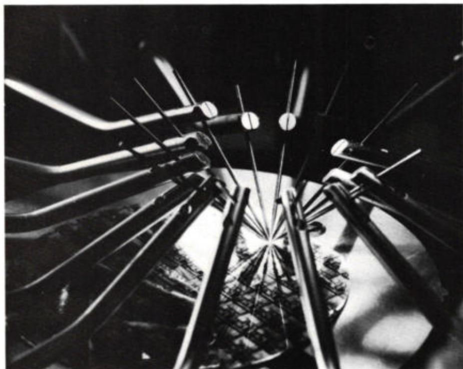
Afb. 3. Het testen van geïntegreerde schakelingen in het IC laboratorium van AEG-Telefunken in Ulm. (Foto: AEG-Telefunken)
