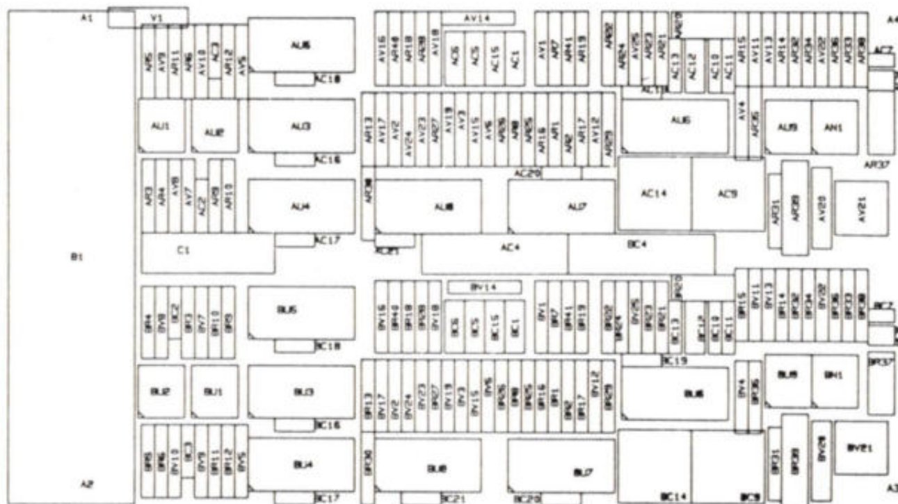
Fig. 1. Componentzijde van de eurokaart die als uitgangspunt dient voor de berekening van het moment waarop het gebruik van een CAD-systeem lonend is.
